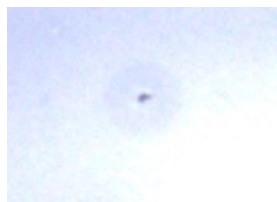
黒ブツ（ \phi 0.15\text{mm} ）
