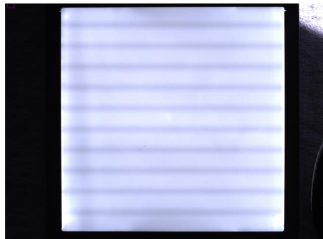
縦方向の視野は約 110 mm、ピクセル数は 3600pixel
